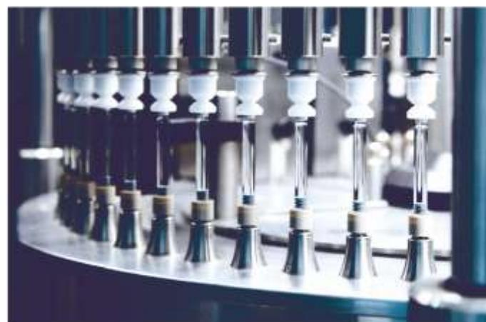
При асептическом производстве возможные микроорганизмы блокируются до начала процесса, и температура продукта не превышает 20 °C.
