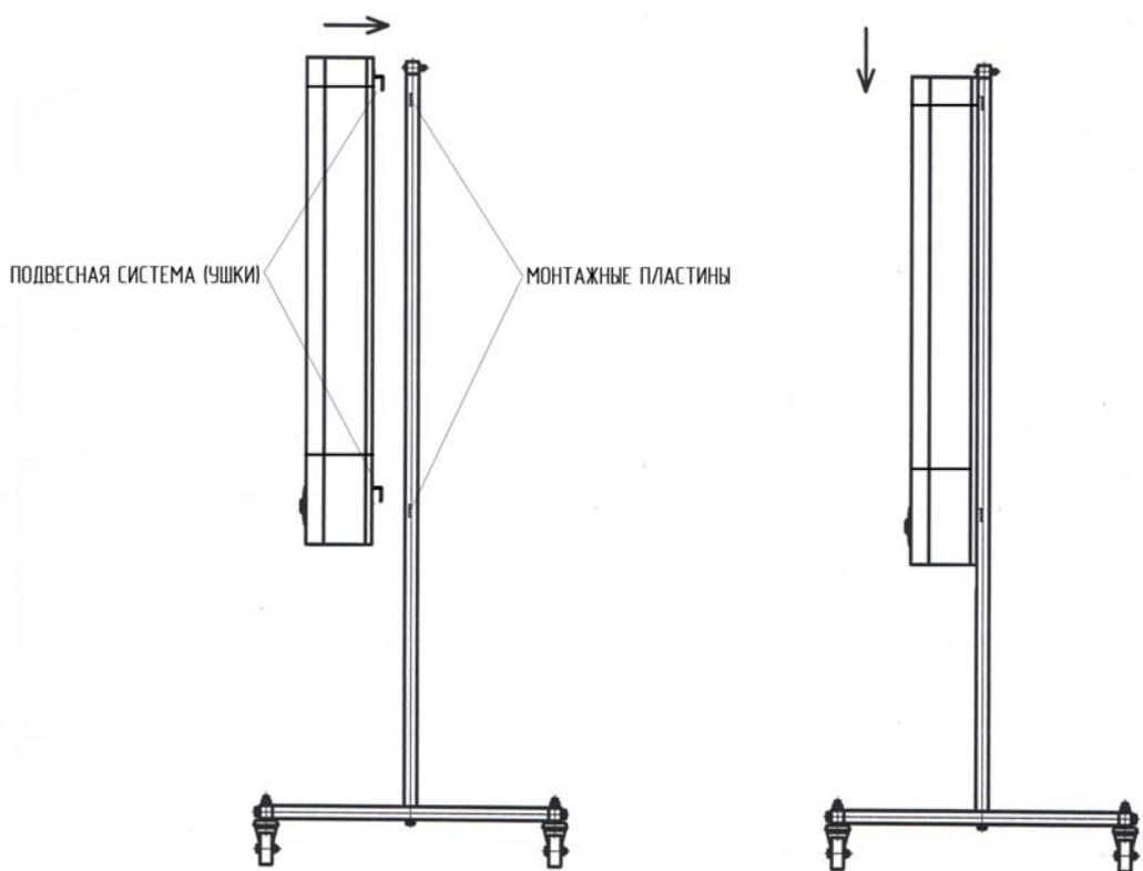
1. Произвести зацепление подвесной системы с монтажными пластинами
